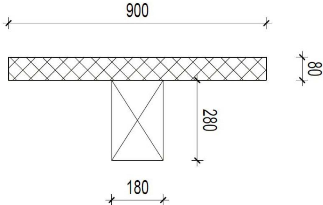
La surcharge de poids propre est de 1,0 kN/m<sup>2</sup>
